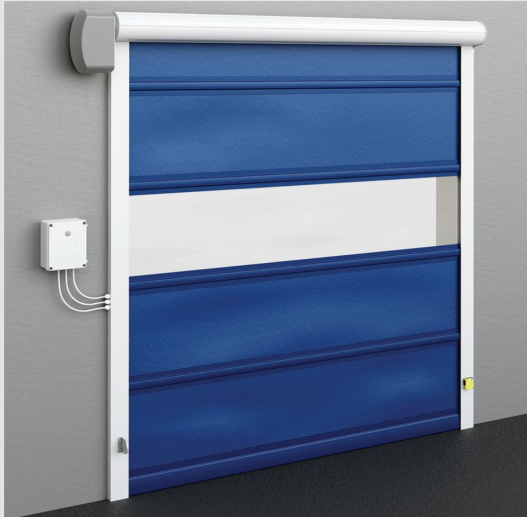
Puerta rápida enrollable construída en perfiles de aluminio lacada en blanco. Cuadro eléctrico con paro suave, finales de carrera mecánicos, pulsador interior. Cuadro de maniobras con botón de arranque. Fococélula de seguridad. Pulsador exterior.
