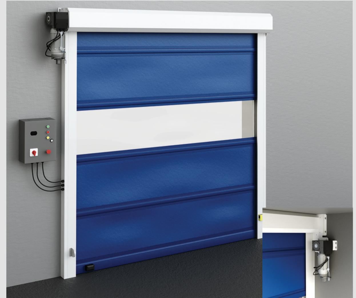
Puerta rápida enrollable construída en perfiles de aluminio lacada en blanco. Cuadro eléctrico y reductora de alta calidad, variador de velocidad en arranque y paro, finales de carrera mecánicos, pulsador interior y exterior, botón de stop, selector de funciones. Central con pulsador de emergencia. Fococélulas de seguridad. Pulsadores estancos interior y exterior. Detector de obstáculos.
